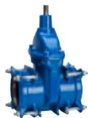
Серия 01/70 Клиновая задвижка Supa Plus™ с фиксирующими муфтами для ПЭ и ПВХ труб Высокопрочный чугун DN40-300 PN16
