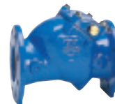
Серия 41/61 Клапан обратный поворотный Без хвостовика С эластичным запирающим DN50-300 PN10/16 Высокопрочный чугун
