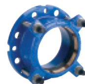
Серия 623/10 Фланцевый адаптер Supa Plus™ Фиксирующего типа для ПЭ и ПВХ труб Универсальная рассверловка Высокопрочный чугун DN40-300 PN10/16
