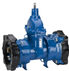
Серия 636 Задвижка клиновая Supa Maxi™ с фиксирующими муфтами для всех видов труб Высокопрочный чугун DN80-300 PN16
