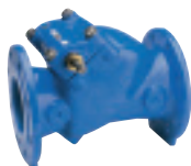
Серия 41/60 Клапан обратный дисковый, с упругим запирающим С хвостовиком DN50-300 PN10/16 Высокопрочный чугун
